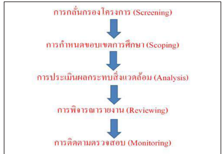
รูปที่ 1 : ระบบการวิเคราะห์ผลกระทบสิ่งแวดล้อมโดยสังเขป
